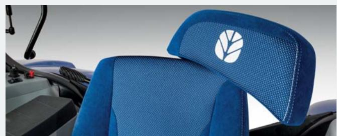
Atât scaunul Dynamic Comfort cât și scaunul Comfort sunt dotate cu inovativul spătar rotativ, proiectat pentru a susține partea superioară a spatelui și pentru a crește, în mod semnificativ, nivelul de confort atunci când scaunul este rotit pentru a monitoriza echipamentele montate în partea din spate.
