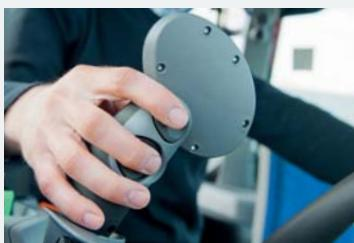
Butonul de pe partea posterioară a CommandGrip permite accesul la alte funcții.
