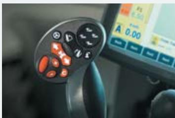
Butoanele sunt iluminate pe fundal pentru a facilita ulterior selectarea comenziilor în condiții de luminozitate redusă.
