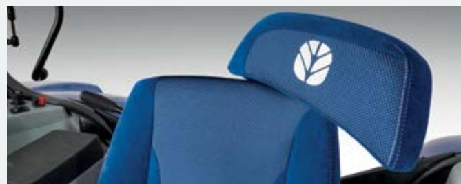
Scaunele Dynamic Comfort și Comfort beneficiază de spătar rotativ, găndit pentru a susține partea superioară a spatei, ceea ce îmbunătățește în mod semnificativ nivelul de confort atunci când scaunul este rotit pentru a controla echipamentele din spatele tractorului.
